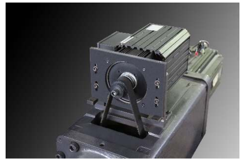
安装高精度的编码器和射出压力传感器
