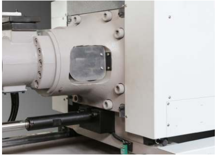
料筒安装法兰式结构
